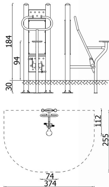
Il dispositivo necessita l'ancoraggio al Pilone
