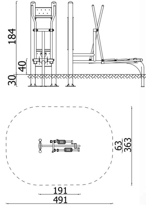
Il dispositivo necessita l'ancoraggio al Pilone.
