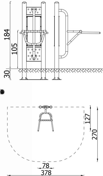
Il dispositivo necessita l'ancoraggio al Pilone
