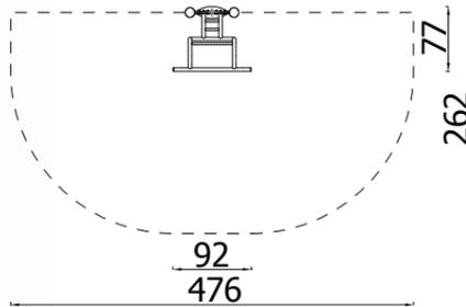
Il dispositivo necessita l'ancoraggio al Pilone
