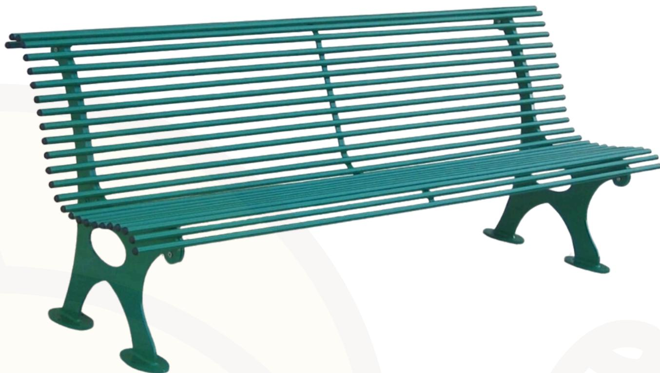
**Struttura:** Composta da supporti in lamiera d'acciaio zincato sagomati con tecnologia laser sp. 60/10 muniti di piastre ovali per l'ancoraggio al suolo e profili in tubo tondo d'acciaio zincato Ø mm. 20 completi di tappi emisferici in PE colore nero.
