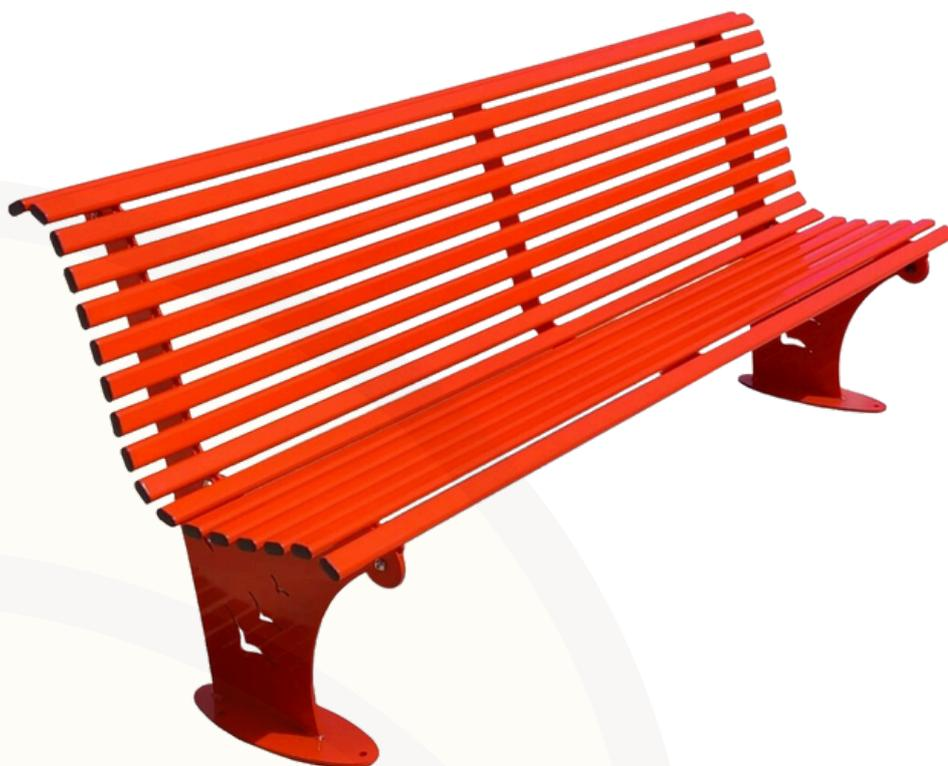
**Struttura:** Composta da supporti in lamiera d'acciaio zincato sagomati con tecnologia laser sp. 60/10 muniti di piastre ovali per l'ancoraggio al suolo e profili in tubolare ovale d'acciaio zincato mm. 40x20 completi di tappi in PE colore nero.
