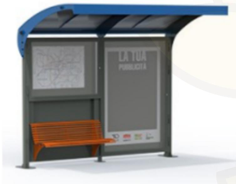
Struttura composta da due montanti verticali laterali in profilato di acciaio con un angolo arrotondato, ogni singolo montante è completo di piastra, alla base, in lamiera zincata. Montante verticale centrale in tubo rettangolare di acciaio completo di piastra, alla base, in lamiera zincata.
