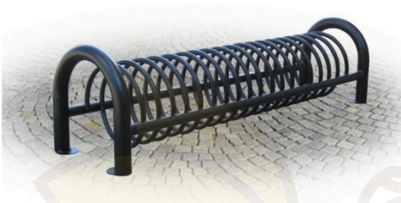
Portabiciclette composto da n. 2 sostegni ad "U" capovolta realizzati in tubo tondo d'acciaio zincato completi di piastra per l'ancoraggio al suolo e spirale realizzata sempre in tubo d'acciaio zincato.
